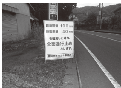
崩土・落石が発生し雨量規制をしている 県道伊東修善寺線
