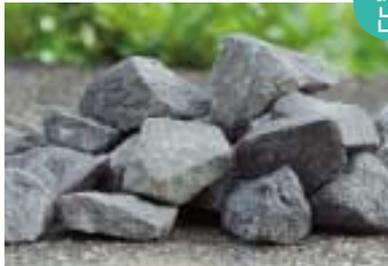
燃やした後は熔融固化して、市外の処理業者の工場に搬出します。
