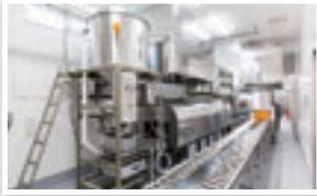
自動炊飯システムで、米の貯蔵から洗米、浸水、炊飯、蒸らしまでの工程が全自動で行われます。炊き立てはもちろん、炊き込みご飯や混ぜご飯など、バラエティ豊かで、おいしいご飯を提供します。
