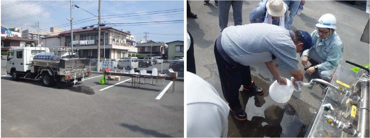
図 4.3.5 応急給水車と非常用ポリタンク
